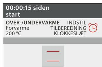
Når denne fase er afsluttet, lyder der et hørbart signal, og displayet angiver, at ovnen har nået den indstillede temperatur.
