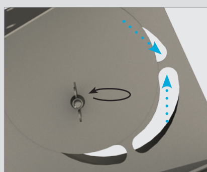
Z patního kolene 87° s konzolou, kde excentricky uložený kotouč umožňuje plynulou regulaci hmotnostního toku spalovacího vzduchu.
