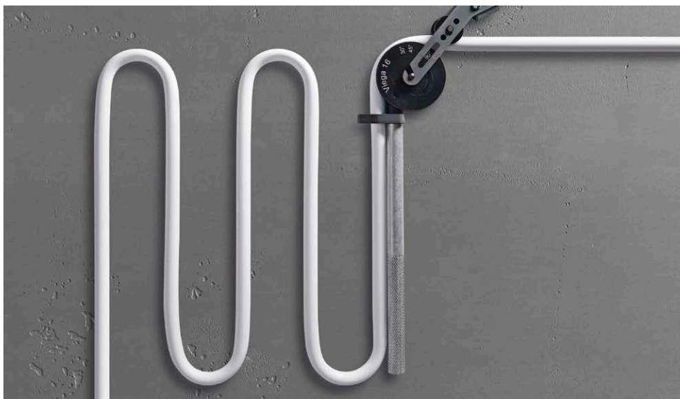
Ohýbacím nástrojem lze velmi snadno vytvořit čisté poloměry.
