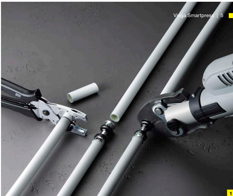
Odpadá časově náročná kalibrace: jednoduše zkrátit, nasadit, slisovat a hotovo.
