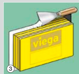
3 Vyplnění řezných hran tmelem.
