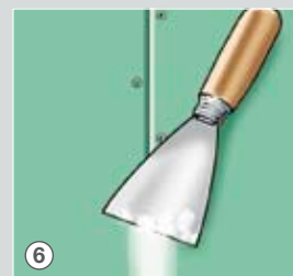
6 Vyplnění styčných hran tmelem.
