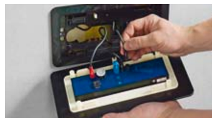
3 Zdroje napětí se připojí k řízení na zadní straně ovládací desky. Kable se vloží do vodička. Alternativě se může použít i schránka na baterie.
