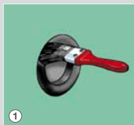
1 Uzavření řezných hran základním penetračním nátěrem.
