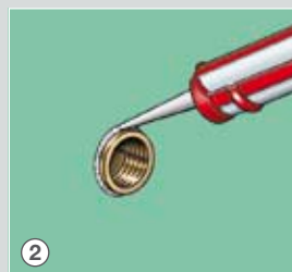
2 Utěsnění kruhové spáry u vodovodních přípojek.
