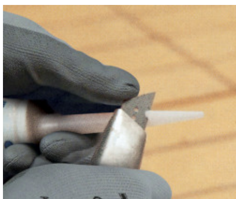
Odříznutí špičky trysky v závislosti na profilu spáry
