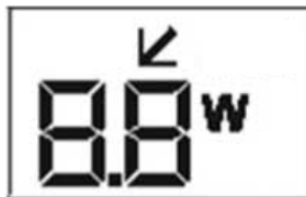
Obr. 9: Displej v provozním režimu Proporciónální regulace tlaku
