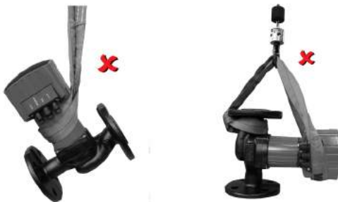
Obr. 2: Nesprávná přeprava čerpadla
