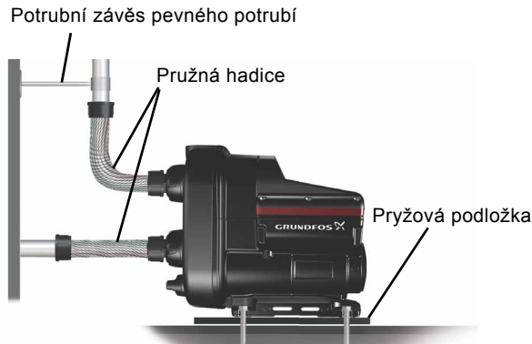
Obr. 4 Jak snížit hluk v instalaci
