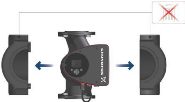
Obr. 3 Instalace tepelně-izolačních krytů na čerpadlo
