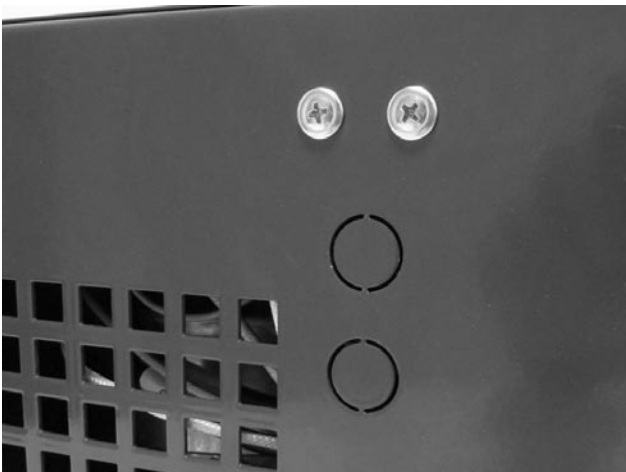
Obr. 11 - nevyložené otvory, dříve pro čidla teploty TS a TV (možno využít pro jiné aplikace)
