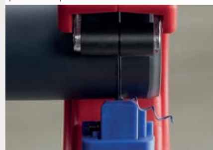
Lze řezat segmenty už od 10 mm. Spirálová tříška vzniká při srážení hran.
