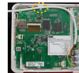
Horní střední výstupek pro upevnění ohnutého kabelu
