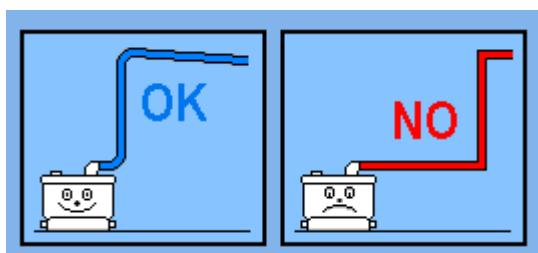
Výtlačné vertikální odpadní potrubí instalujte ihned u čerpadla, maximálně 0,5 metru od středové osy čerpadla, bez úhybu a ostrých kolen.
