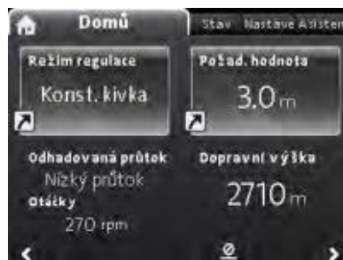
Obr. 63 Příklad: Parametry menu "Domů"
