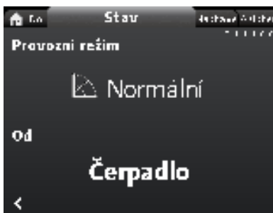
Obr. 59 Příklad dílčího menu "Provozní stav" zobrazujícího čerpadlo běžící v běžném režimu v soustavě s více čerpadly.
