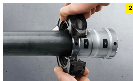
Pro lisování spojek Megapress od velikosti \frac{1}{4} palce se používají výhradně lisovací prstence s tažnou kloubovou čelistí. U menších rozměrů mezi \frac{3}{8} až 1 palcem lze zvolit jak lisovací čelisti, tak lisovací prstence s tažnou kloubovou čelistí.
