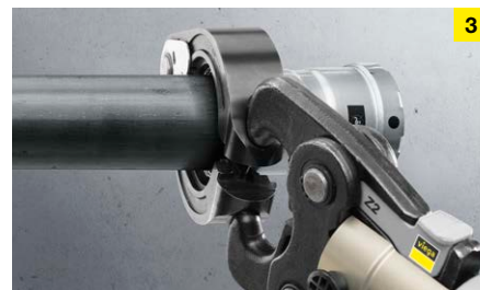
Spojka se ve vteřině lisovacím nástrojem Viega slisuje a vytvoří silové spojení s trubkou.
