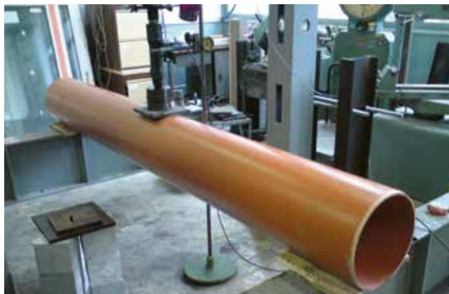
Laboratorní zkouška průhybu
