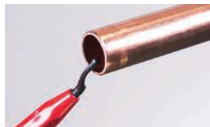
3. Odhrotujte trubku zevnitř i zvenčí
