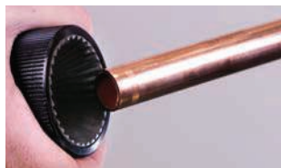
2. Odhrotujte trubku zevnitř i zvenčí
