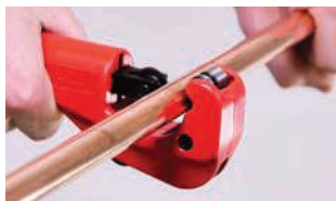
1. Upravte délku měděné trubky
