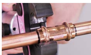
11. Nasadte lisovací čelist pod pravým úhlem
