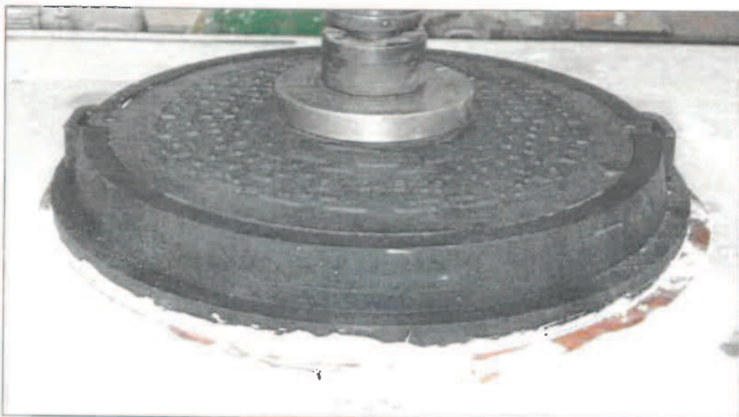
Obr. 2: Uspořádání zatěžovací zkoušky – vzorek číslo 19/494/1
