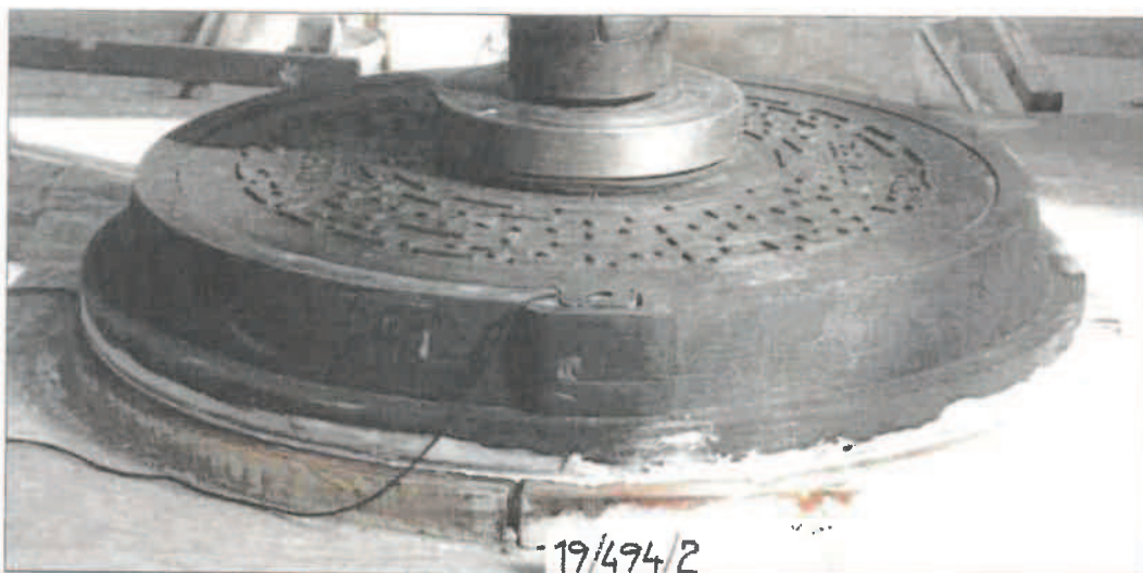
Obr. 3: Uspořádání zatěžovací zkoušky – vzorek číslo 19/494/2
