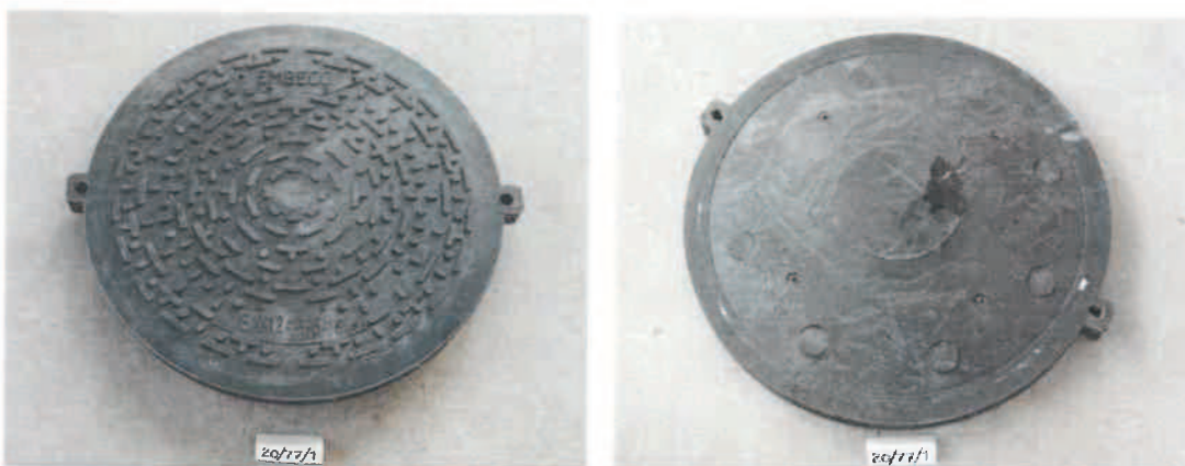
Obr. 5,6: Vzorek číslo 20/77/1 po zkoušce únosnosti – bez porušení
