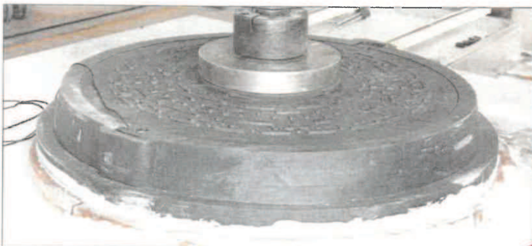
Obr. 4: Uspořádání zatěžovací zkoušky po zkoušce odolnosti proti únavě materiálu – vzorek číslo 19/494/3
