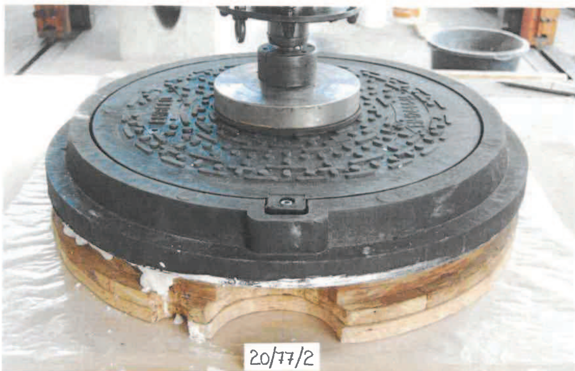
Obr. 3: Uspořádání zatěžovací zkoušky – vzorek číslo 20/77/2
