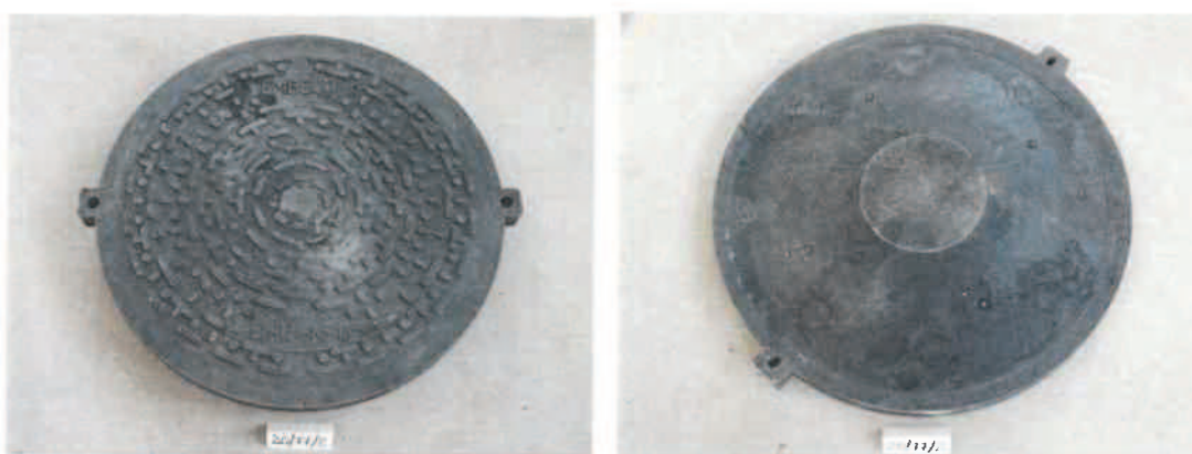
Obr. 7,8: Vzorek číslo 20/77/2 po zkoušce únosnosti – bez porušení
