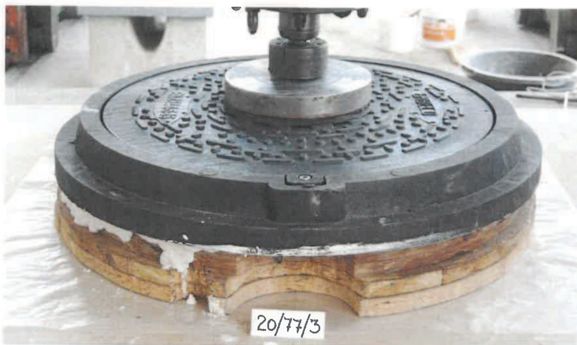
Obr. 4: Uspořádání zatěžovací zkoušky – vzorek číslo 20/77/3
