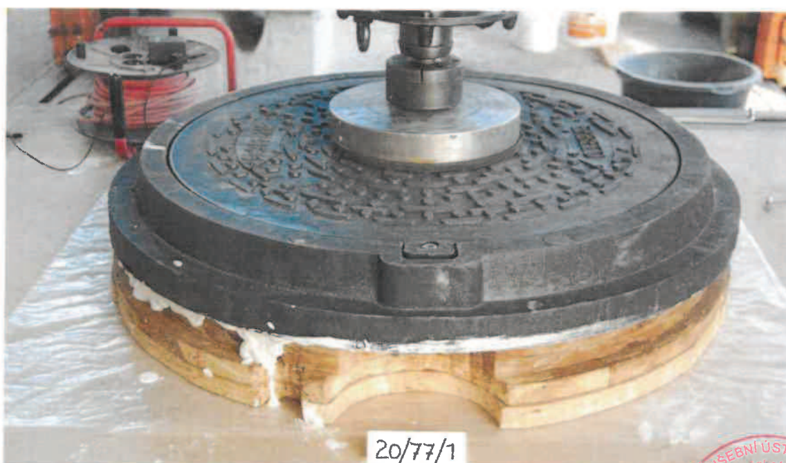
Obr. 2: Uspořádání zatěžovací zkoušky – vzorek číslo 20/77/1
