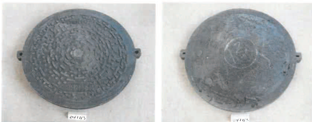
Obr. 9,10: Vzorek číslo 20/77/3 po zkoušce únosnosti – bez porušení
