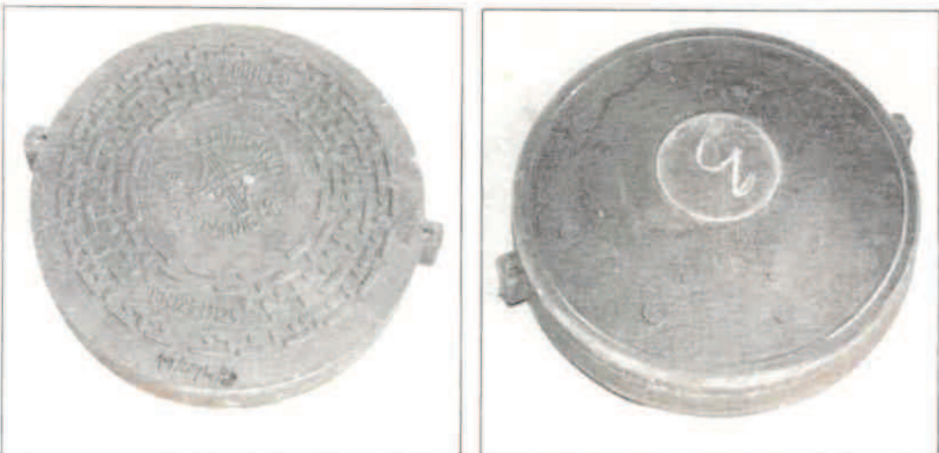
Obr. 9,10: Vzorek číslo 19/494/3 po zkoušce únosnosti a zkoušce odolnosti proti únavě materiálu – bez porušení
