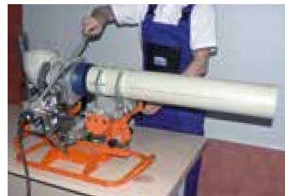
Upnutí do přípravku a vycentrování, poté nahřívání
