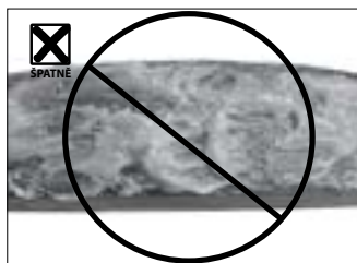
Nesprávně nanesené standardní ploché těsnění s příliš velkým množstvím maziva
