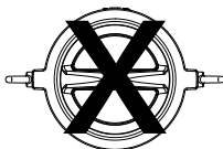
Nesprávná orientace pro Vodorovná instalace
