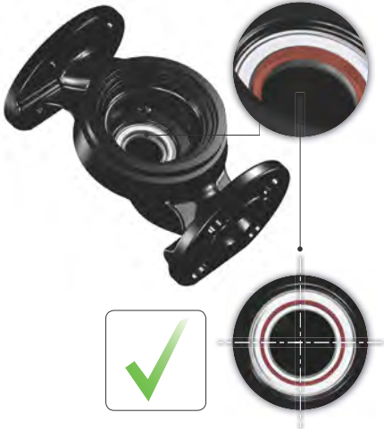
Obr. 11 Správně vystředěná těsnicí soustava
