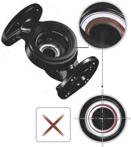
Obr. 12 Nesprávně vystředěná těsnicí soustava
