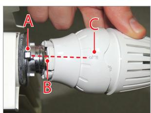
**2)** Nasadte termostatickou hlavu na ventil tak, že výstupek na ventilu (A) zapadne do mělkého vybrání na termostatické hlavě (B) a indikátor nastavení (C) jsou zarovnány v ose.
